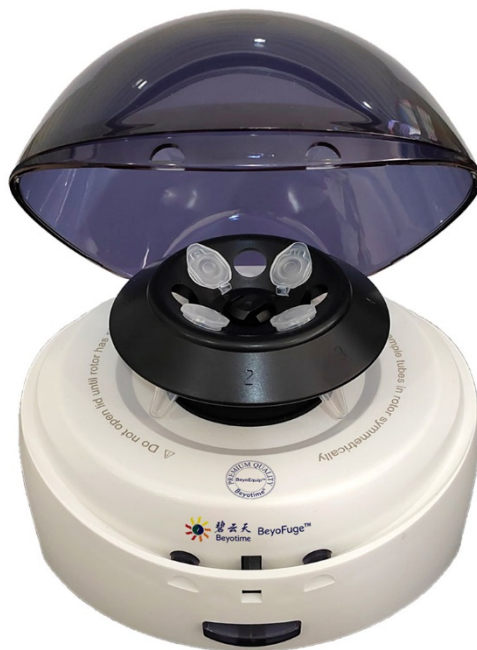
图1. BeyoFuge™掌上离心机(E6686)示意图。
